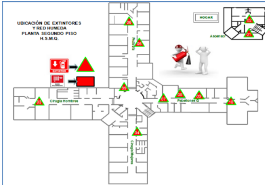
Figura 28: Distribución de extintores segundo piso hospital San Martín de Quillota
